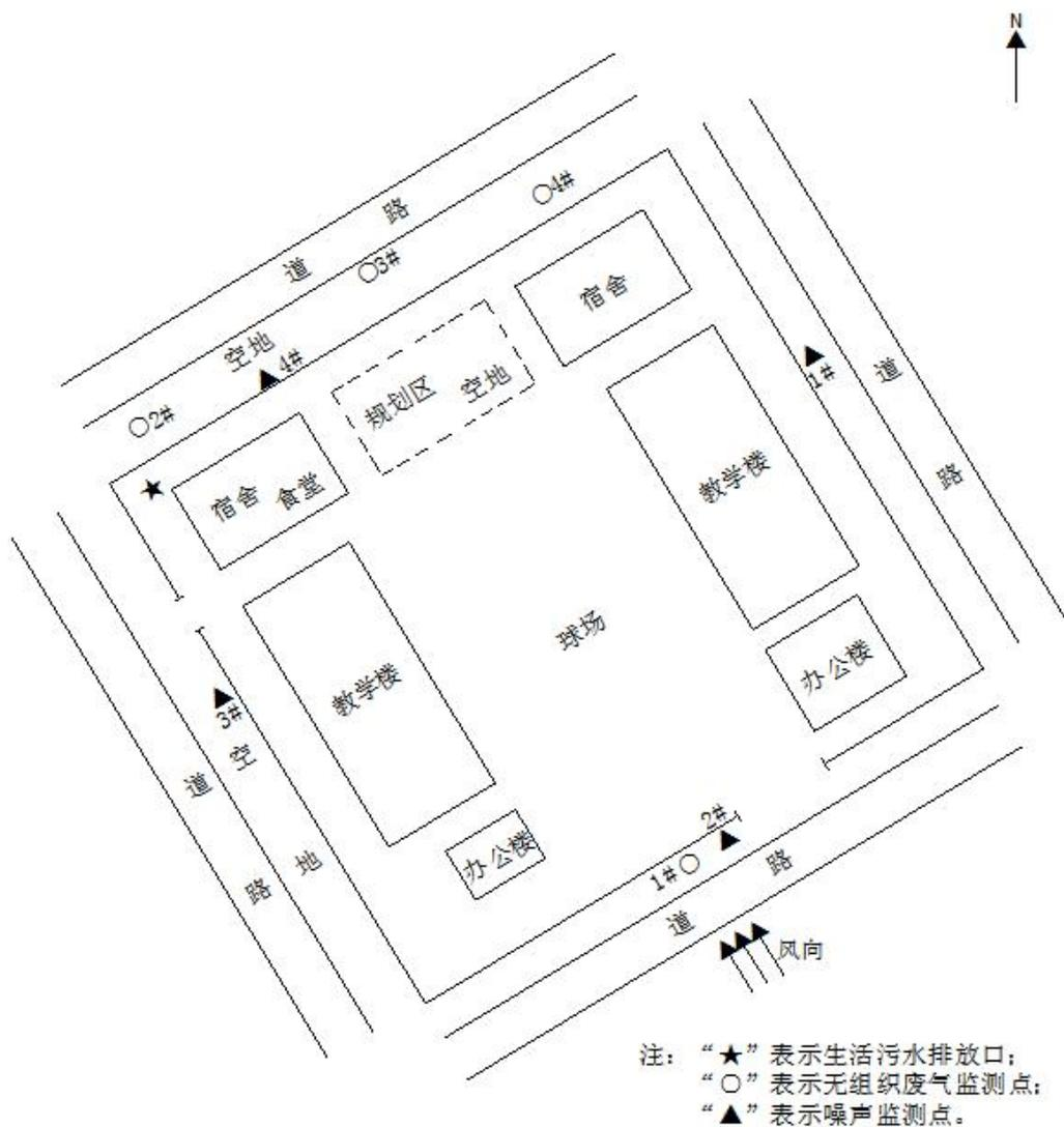
图 7-1-1 生活污水、废气、噪声布点图
