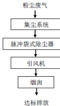
废气处理系统工艺简图
